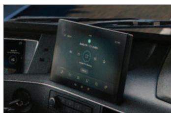
9인치 측면 디스플레이(네비게이션/ 보조석 사각지대 카메라/오디오 시스템)
